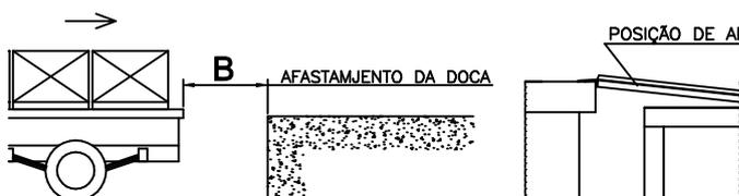
1. Posicione o veículo, este deverá ficar alinhado com o nivelador e afastado respeitando de acordo com a distância "B" indicado para o modelo do nivelador.
