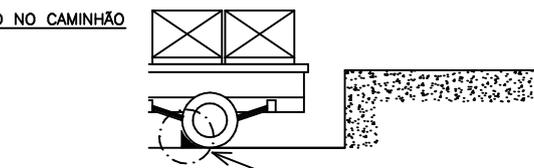
2. Utilizando-se o calço, calce uma das rodas do veículo, evitando-se assim que o veículo se movimente durante a operação e cause acidentes.
