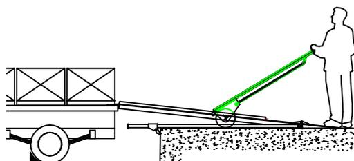
3. Posicione o nivelador Portátil no caminhão com o carrinho de transporte observando a distância recomendada para o modelo de seu nivelador
