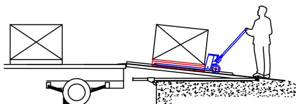
5. Com a pestana (1) apoiada na doca iniciar a operação de carga e descarga através de palleteira sempre observando a posição do braço e conjunto de travamento para não saírem da posição.
