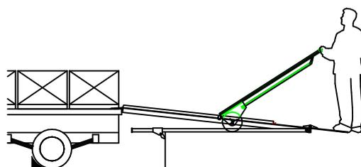
6. Terminado a operação, soltar o braço e o conjunto de travamento e recolher o nivelador com o carrinho de transporte.
